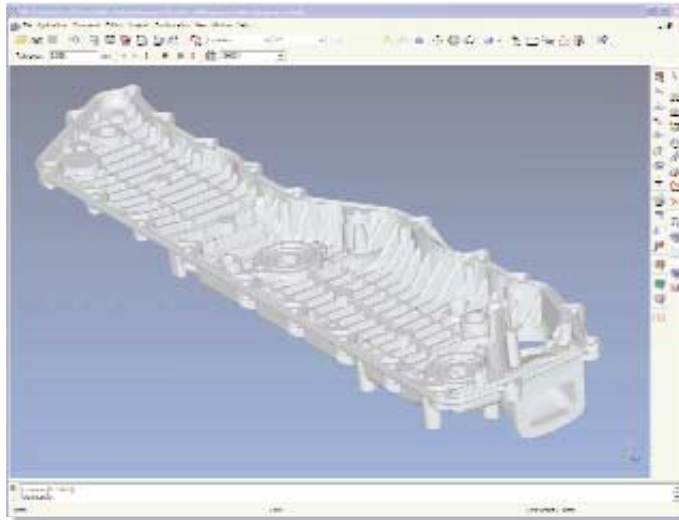
Auch sehr komplexe Modelle bereiten 3D-Evolution bei der Feature-Erkennung keine Probleme. Die grafische Benutzeroberfläche des Programms beinhaltet auch den so genannten Featureplayer, bei dem die Modellhistorie Schritt für Schritt abgespielt werden kann.
